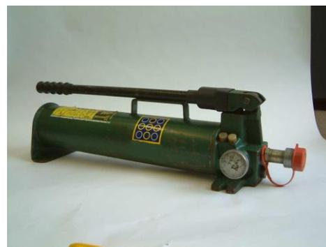
Pompa idraulica manuale
